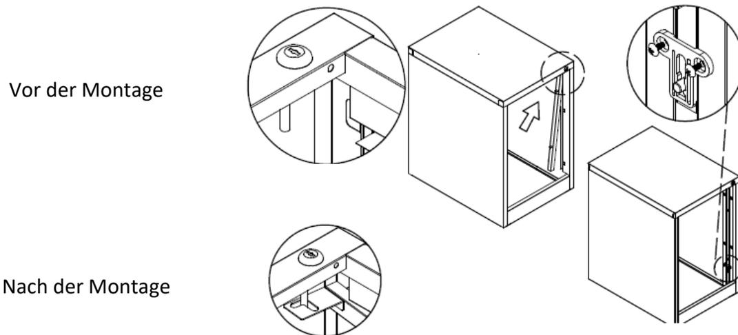
Befestigen Sie die Verriegelungsstange mit dem Verbindungsstück, wie abgebildet.
