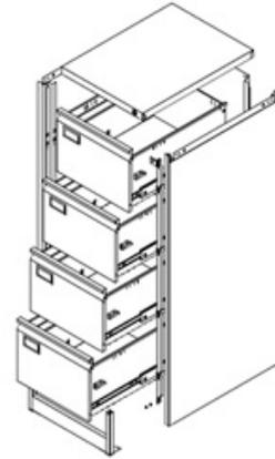
Befestigen Sie mit Schrauben die vordere und hintere Konstruktion mit der rechten und linken Seitenwand.
