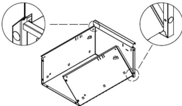
Zerlegen Sie die Schubladekonstruktion und mit der Frontplatte verbinden
