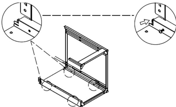
Befestigen Sie mit Schrauben die Rückwand, rechte und linke Seitenwand.
