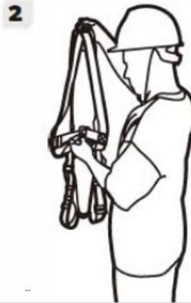
2. Wenn die Brust-, Hüft- und/oder Beingurte geschlossen sind, lösen Sie die Gurte und schließen Sie die Schnalle des Auffanggurtes.
