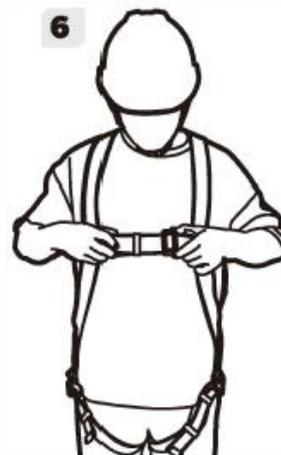
6. Bringen Sie den Brustgurt an, er sollte sich in der Mitte des Brustbereichs befinden. Stellen Sie seine Spannung so ein, dass die Schultergurte jeweils in der Mitte der Schulter liegen. Stellen Sie sicher, dass sich die Gurte nicht verwickeln. Fädeln Sie das überschüssige Gurtband durch die Schlaufenhalterungen.
