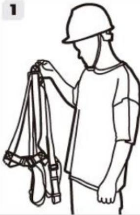
1. Nehmen Sie den Auffanggurt aus der Verpackung und halten Sie ihn am hinteren Spannungsfest.
