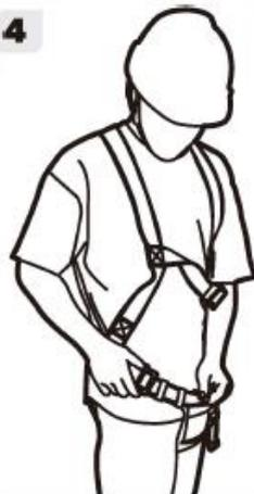
4. Ziehen Sie den Oberschenkelgurt über den Schritt und sichern Sie jeden Gurt. Achten Sie darauf, die Gurte nicht zu überkreuzen. Stellen Sie sie ein, indem Sie das freie Ende des Gurtes verkürzen und verlängern, so dass der Gesäßgurt fest unter dem Gesäß sitzt.
