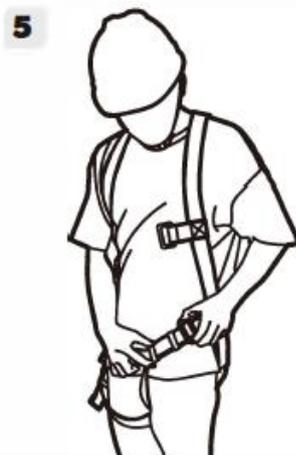
5. Ziehen Sie den anderen Oberschenkelgurt durch den Schritt und schließen Sie jeden Gurt. Achten Sie darauf, die Gurte nicht zu überkreuzen. Stellen Sie sie ein, indem Sie das freie Ende des Gurtes verkürzen und verlängern, so dass der Gesäßgurt fest unter dem Gesäß sitzt.
