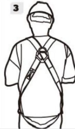
3. Legen Sie den Auffanggurt an, indem Sie die Schultergurte schrittweise anlegen und die Gurte so über die Schultern legen, dass der D-Ring sich in der Mitte des Rückens zwischen den Schulterblättern befindet. Achten Sie darauf, dass Sie diese nicht verdrehen.
