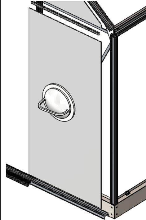
Verwenden Sie **F20**, um das Glas zu greifen und zu installieren.
