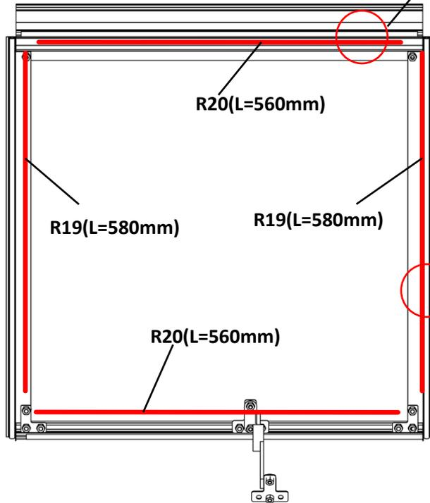
Dehnen Sie beim Einbau das Gummiband aus, legen Sie es ein und passen Sie es dann auf die Länge an der linken und rechten Seite an.
