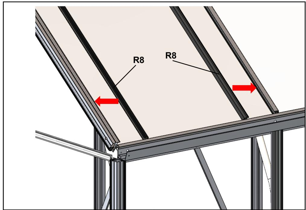
Installieren Sie Leisten zur Befestigung jedes einzelnen Glasstücks.
