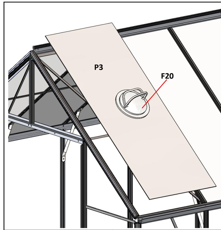
Verwenden Sie **F20**, um das Glas zu greifen und zu installieren.
