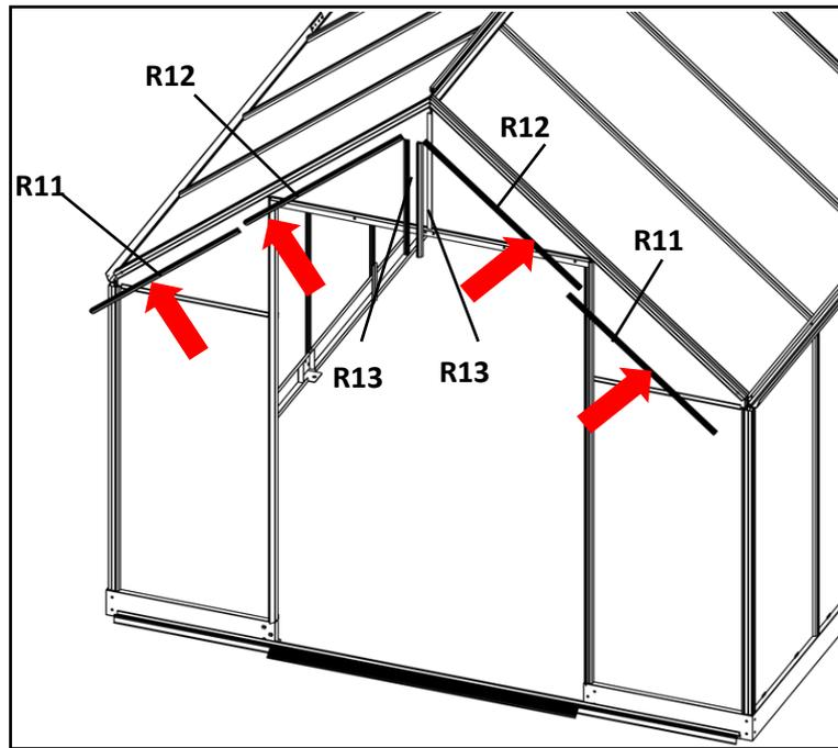
Installieren Sie Leisten zur Befestigung jedes einzelnen Glasstücks.
