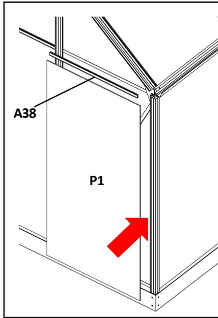
Verwenden Sie **F20**, um das Glas zu greifen und zu installieren.
