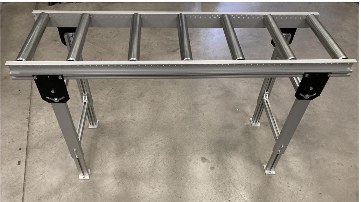
1) Verwenden Sie die Profile und Rollen, um den oberen Teil des Förderers mit den erforderlichen Rollenabständen zu konstruieren.
