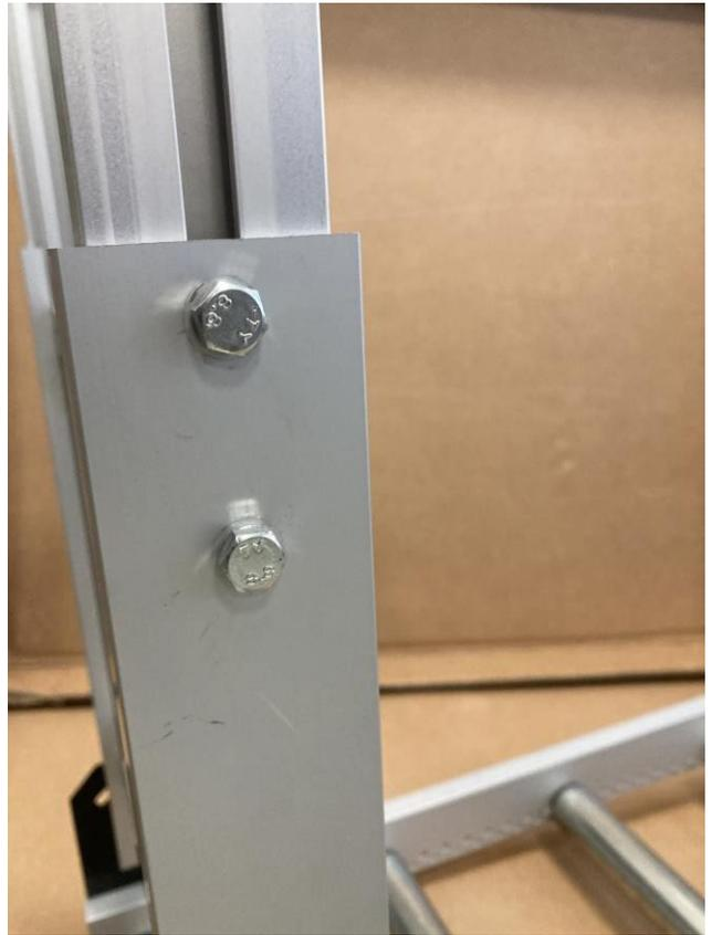
6) Verwenden Sie die beiden vertikalen Schrauben an der schwarzen Konsole, um die gewünschte Neigung des Förderbandes einzustellen. Ziehen Sie die Schrauben anschließend gut fest.
