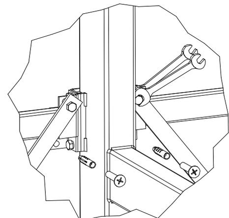
Das Konsolenregal muss während der Montage horizontal und vertikal korrekt installiert werden (die Verwendung einer Wasserwaage ist erforderlich). Beim Einsetzen der einzelnen Komponenten müssen die Schrauben vorsichtig angezogen werden. Nach Abschluss der Montage müssen die Schrauben weiter angezogen werden. Das Konsolenregal muss sowohl am Boden als auch an der Wand angefestung sein.
