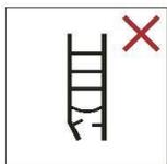
c) Prüfen der Leiter nach der Lieferung. Vor jeder Benutzung Sichtprüfung, um festzustellen, dass die Leiter nicht beschädigt ist und sicher verwendet werden kann. Keine beschädigte Leiter verwenden
