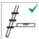
b) Stützleitern mit Stufen müssen so verwendet werden, dass sich die Stufen in einer horizontalen Position befinden.
