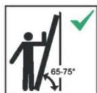
a) Die Leiter muss in der richtigen Position aufgestellt werden, mit dem richtigen Winkel für die Stützleitern (Neigungswinkel 65-75°, ca. 1:4), jeweils mit den Sprossen oder Stufen in der Ebene und vollständig geöffnet für die Stehleitern.
